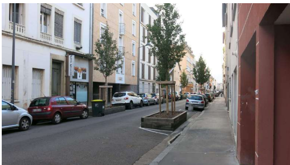
Illustration 33 : L'aménagement de cet alignement d'arbres tend à effacer le caractère routier de cette voirie. La stratégie de végétalisation de la voirie sur les emplacements de stationnement nécessite également d'apporter une attention particulière à la co-visibilité au droit des entrées charretières.
