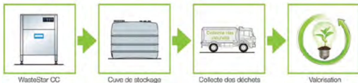
Illustration 41 : Principe général du système WasteStar (illustration tirée du « Livre blanc des déchets de restauration »)
