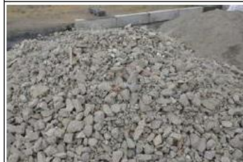
Béton de démolition
