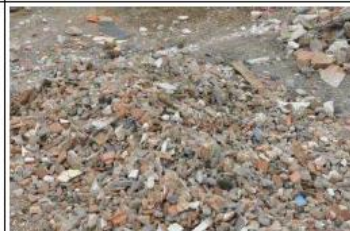
Déchets de déconstruction bâtiment en mélange
